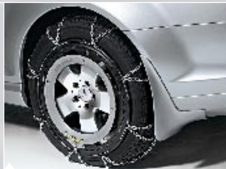
Catene da neve Rudmatic-Disc Grazie alla staffa si montano e smontano con estrema facilità. Il robusto anello in materiale plastico protegge il cerchio dai graffi.
