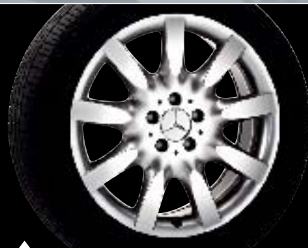
Cerchio a 9 razze Superficie: argento Sterling Dim.: 8,5J x 18 ET 43 | Pneumatico: 255/45 R18 A richiesta per le ruote posteriori Dim.: 9,5J x 18 ET 43 | Pneumatico: 275/45 R18
