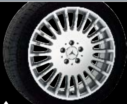
Cerchio a razze | Superficie: argento Sterling Dim.: 8,5J x 19 ET 43 | Pneumatico: 255/40 R19 A richiesta per le ruote posteriori Dim.: 9,5J x 19 ET 43 | Pneumatico: 275/40 R19
