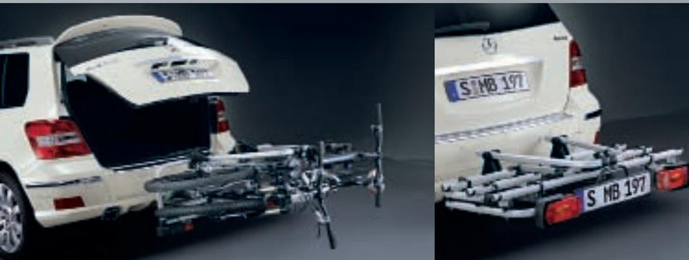
*Il portabiciclette posteriore carico si può inclinare all'indietro, permettendo così di aprire comodamente il bagagliaio.*
